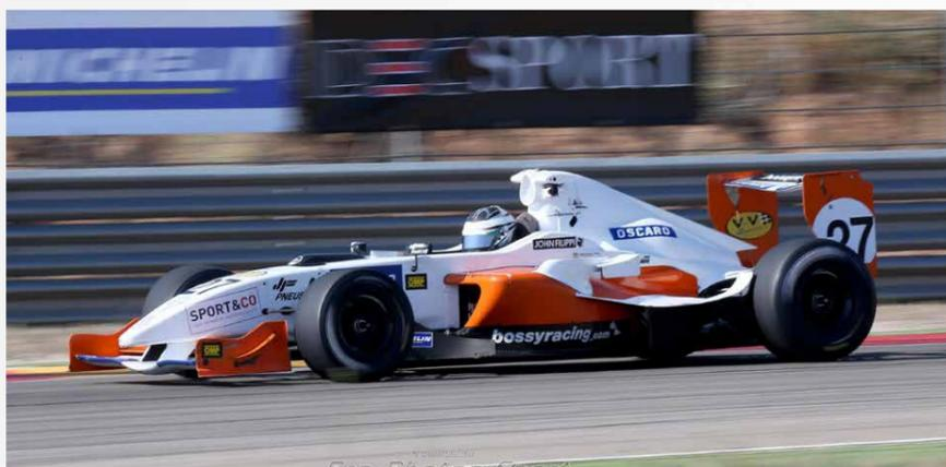
une Formula Master, monoplace de type F3 à moteur Honda 2 litres de 250 cv, dans laquelle il a découvert les subtilités des réglages aérodynamiques et la gestion du transfert de masses, éléments essentiels en voiture.
